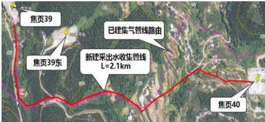
图2.4-3 焦页 39-焦页 40” 管线走向平面图
