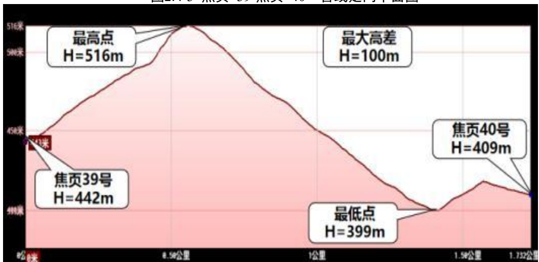
图2.4-4 焦页 39-焦页 40” 管线走向剖面图
