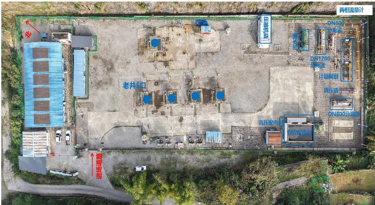
图2.3-4 39号集气站平面布置图
