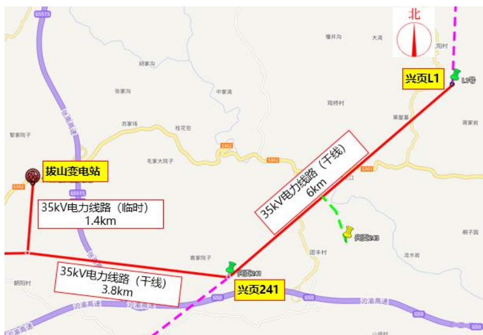
图 2.4-1 兴页 L1HF 试采站电网建设图
